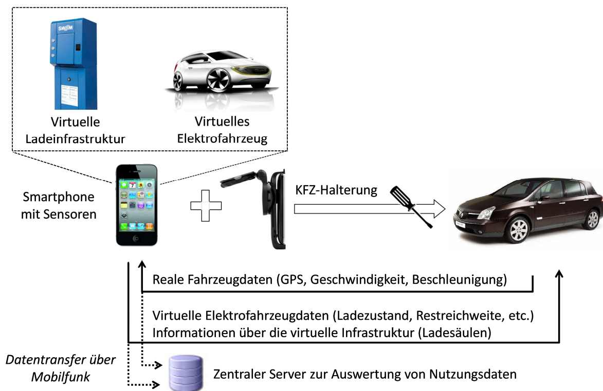
Bild 5: Gesamtstruktur einer virtuellen Fahrzeug- und Infrastrukturuntersuchung
